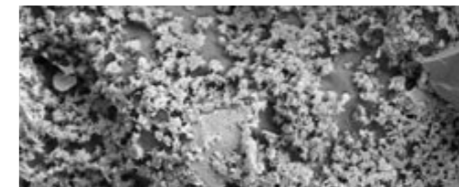
Kryoskopický snímek X-SEED® pořízený elektronovým mikroskopem (CryoSEM): Aktivní krystaly rostoucí mezi cementovými zrny
